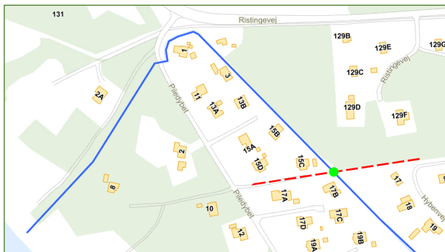
Figur 1. Krydsning (grøn) med elkabel (rød) af afløbet fra Piledybet (blå).
